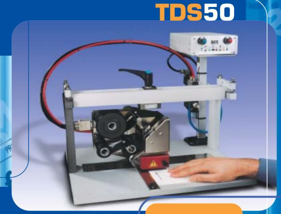
Die TDS 50 ist eine halbautomatische Tischdruckstation für Faltschachteln, Beutel, Etiketten und Blisterzuschnitte.
